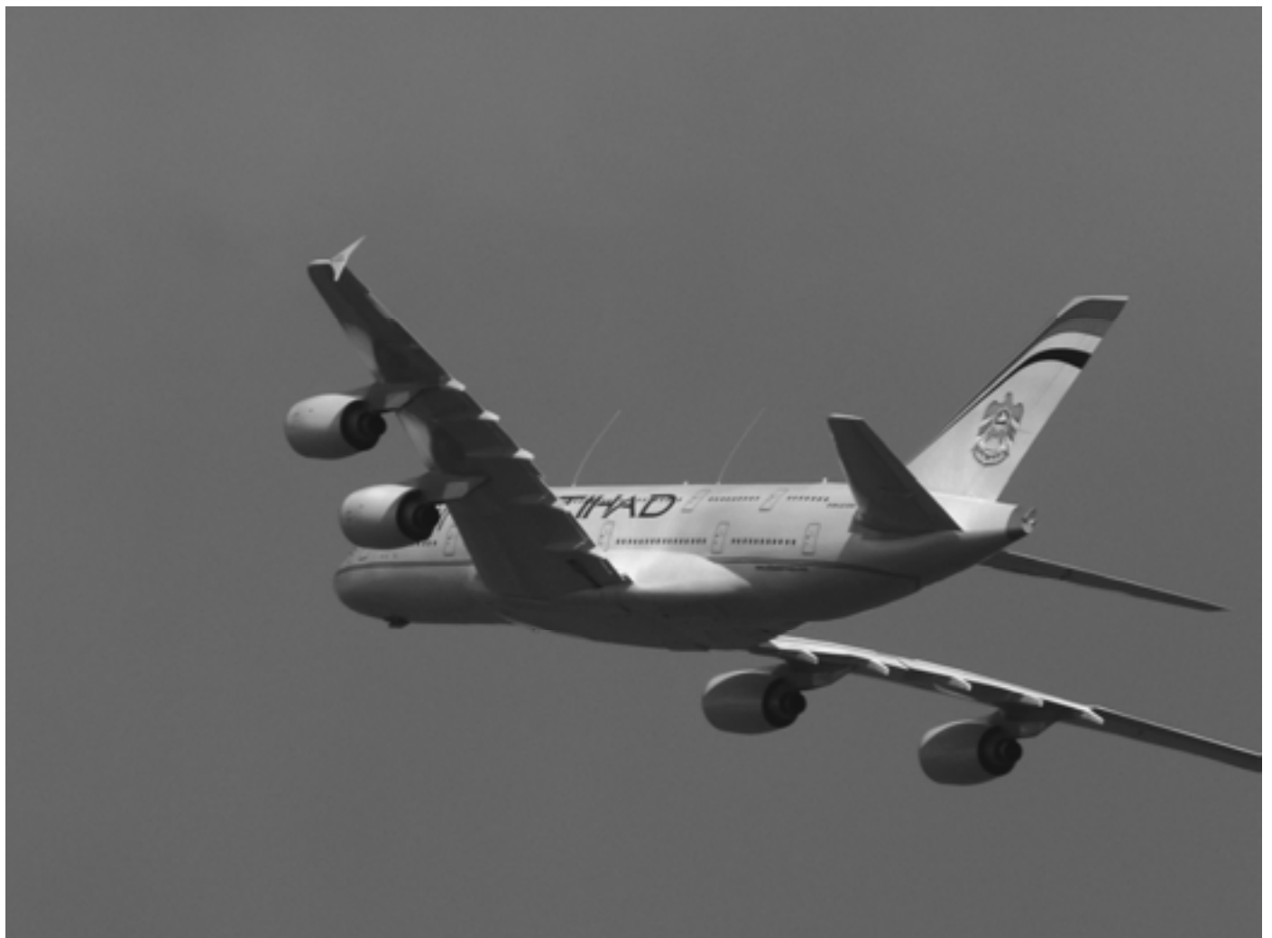
Dieses grösste je gebaute Modell war der Star der Jetmesse in Bad Neuenahr. Die A380 wiegt 120 kg und wird von vier 20kg-Turbinen angetrieben!
